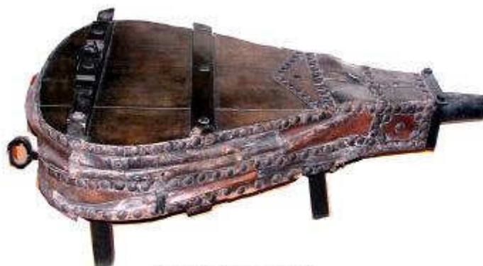
Soufflet de la forge de LAZ Long.: 150, largeur 70 cm
