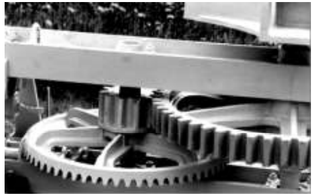
Détails engrenages d'un manège à chevaux. Restauration E. Gueguen 2003.
